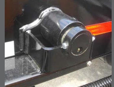
Rouleaux de 5" graissable avec bague d'aluminium bronze.
