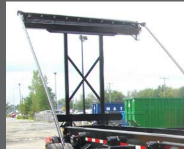
Enrouleur de toile électrique 12V, 2 bras latéraux avec ressorts en torsion.
