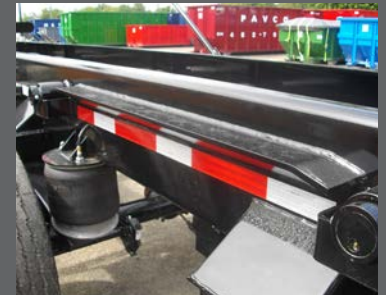
Supports entre les rouleaux pour un meilleur glissement.
