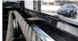
Câble de levage 1" (6 x 26-fils capacité de 106 000 lb).
