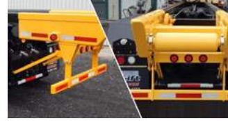
Pare-chocs arrière ICC auto retractable mécaniquement.
