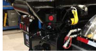
Raccordement hydraulique sous tension, crochet de levage.
