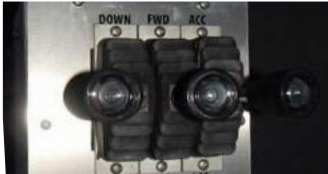
Commandes ergonomiques pneumatique et hydraulique dans la cabine.
