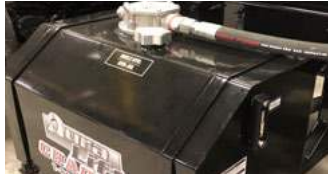
Réservoir hydraulique de 40 gallons avec filtre à huile immergé de 10 microns et jauges de niveau et de température d'huile.
