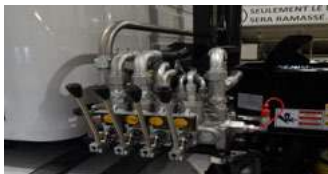
Bloc valve SALAMI 37 GPM zingué opérable hors cabine.
